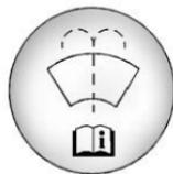
Abra el tapón que tiene el símbolo del lavaparabrisas. Agregue líquido para lavaparabrisas hasta llenar el tanque. Vea en *Vista general del compartimiento del motor* ⇨ 297 la ubicación del depósito.
