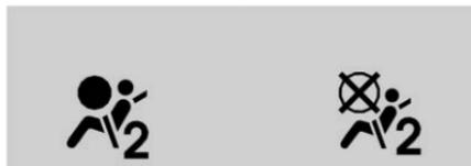
Cuando se arranca el vehículo, el indicador de estado de la bolsa de aire del pasajero encenderá los símbolos para on (encendido) y off (apagado), durante varios segundos a modo de revisión al sistema. Entonces, después de varios segundos, el indicador de estado iluminará ya sea el símbolo on (encendido) u off (apagado) para informarle el estado de la bolsa de aire exterior y bolsa de aire de rodilla del pasajero.
