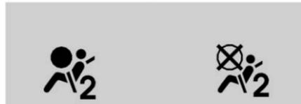
Los símbolos del indicador de estado de la bolsa de aire del pasajero se iluminarán por varios segundos como una verificación del sistema. Entonces, después de varios segundos más, el indicador de estado se iluminará para indicarle el estado de la bolsa de aire delantera del pasajero externo delantero y de la bolsa de aire de las rodillas. Vea *Indicador de estado de bolsa de aire del pasajero* ⇨ 108.
