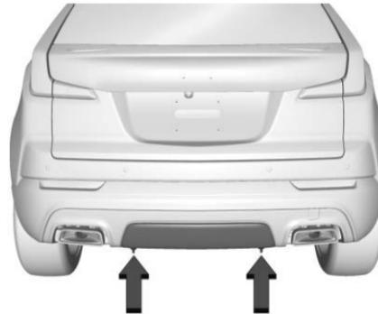
1. Retire los sujetadores para retirar la cubierta del gancho de remolque.
