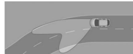
Para activar AFL, ajuste el control de luz exterior en la posición Auto, y el sistema de Faros adaptativos está activo. Vea *Controles de luz exterior* ⇨ 130.
