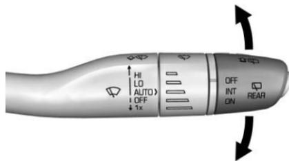
Los controles del limpiador/lavador de la ventana trasera se encuentran en el extremo de la palanca del limpiaparabrisas.
