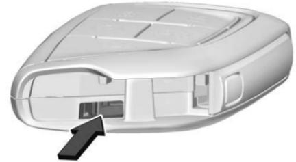
2. Use la hoja de la llave mecánica en la ranura para retirar la cubierta de la batería manualmente.
