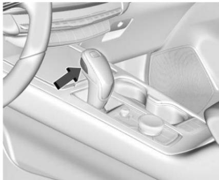
Este vehículo está equipado con transmisión controlada electrónicamente. El botón de liberación de bloqueo de cambios está diseñado para evitar que se cambie inesperadamente fuera de P (Estacionamiento) excepto que la ignición
