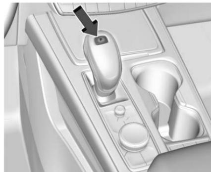
**P** : Esta posición bloquea las ruedas motrices. Use P (Estacionamiento) cuando arranque el motor para evitar que el vehículo se mueva fácilmente.
