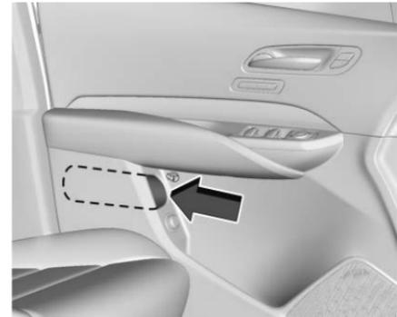
Deslice un paraguas compacto de no más de 6 cm (2.36 pulg.) de diámetro en la abertura en la puerta del conductor o del pasajero.
