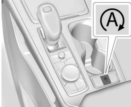
La función automática de paro/arranque del motor se puede desactivar y activar presionando (A). El Paro/arranque automático se activa cada vez que arranca el vehículo.
