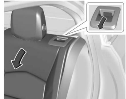
3. Jale la palanca en la parte superior del respaldo para desbloquearlo y plegar el respaldo hacia adelante.
