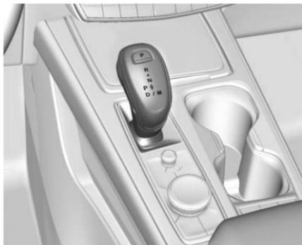
El patrón de cambios se muestra en la parte superior de la palanca de cambios. La posición de velocidad seleccionada se iluminará en rojo en la palanca de cambios, mientras que todas las demás se
