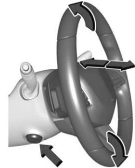
Presione el control para mover la inclinación y el ajuste telescópico del volante hacia arriba y hacia abajo o hacia adelante y hacia atrás.
