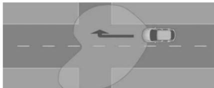
Si está equipado, la luz de poblado se activa automáticamente a una velocidad hasta 55 km/h (34 mph).
