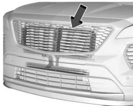
El vehículo puede contar con un sistema de obturador diseñado para ayudar a mejorar la economía de combustible. Mantenga el sistema de obturador libre de desechos, nieve y hielo. Si la luz revisa el motor está activada, verifique si el sistema de obturador está libre de desechos, nieve o hielo.
